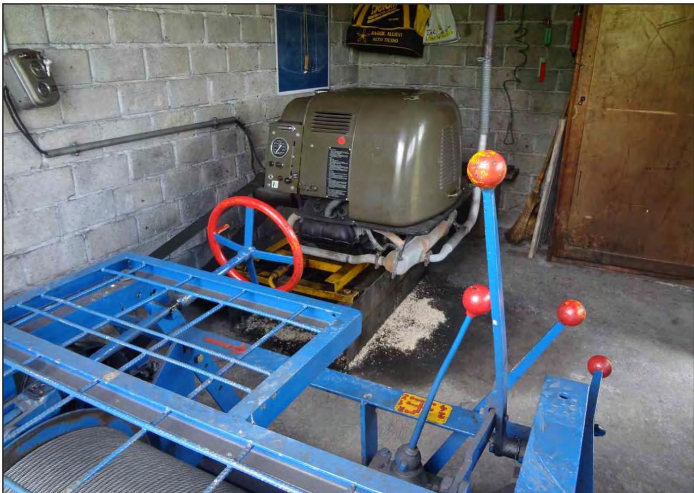
*Aktuelle Situation: Antrieb mit Seilwinde und Benzinmotor. Foto FRC*
