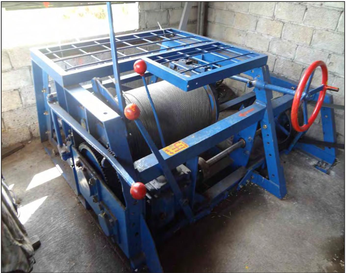
*Die von Hand zu bremsende Seilwinde. Foto FRC*
